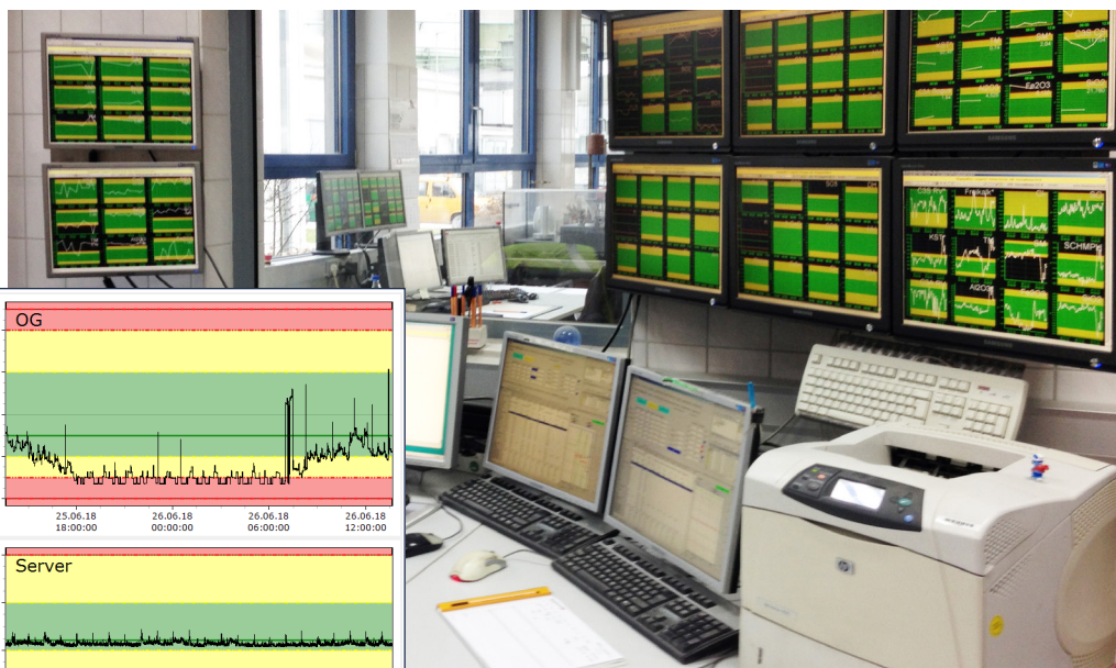
QS-Produktionslabor mit gleichzeitiger Darstellung von Prozess- und Labordaten. (mit freundlicher Genehmigung der Dyckerhoff GmbH)
